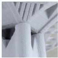
Die Schichtung ergibt eine feine horizontale Oberflächenstruktur. Dies ist bei der Ausrichtung des Modells im Bauraum zu berücksichtigen
