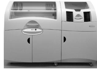
Beim Z-Printer 650 handelt es sich um ein pulver-basiertes Drucksystem. Das Modell wird erzeugt, indem nach und nach Pulverschichten einer Stärke von 0,1 mm aufgetragen und auf Basis von Tintenstrahl-Druck-Technik mit Bindemittel versehen werden.
