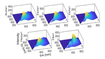
Einzelspektren der Holzarten, jeweils 1 Prüfkörper. Raleigh-Streuung ausgefiltert
